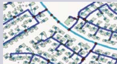
Rozbudowany system kanalizacji ciśnieniowej
