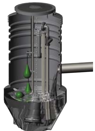
Odpowiednia konstrukcja przepompowni ze skosami w dnie zbiornika zapobiega osadzeniu się nieczystości.
